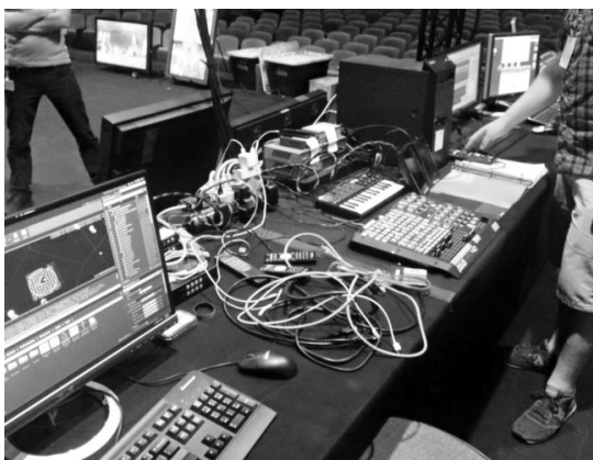
تصویر ۵ - بازگشت - کنترلر MIDI برای نشانه‌های نوری و جلوه‌های صوتی و بصری (عکاس: اتوماس گلدبرگ) (چومی، ۲۰۱۷: ۷۱)
